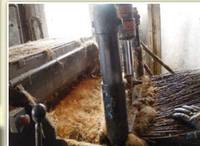
A héjában főzött barnavesszők gépi hántolása
