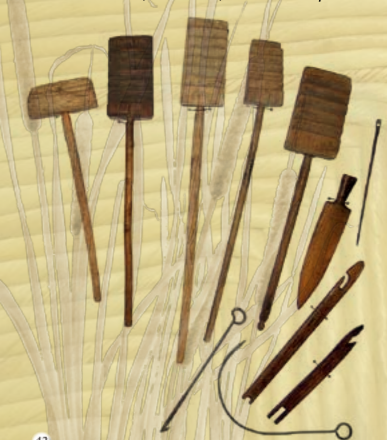
A nádtető készítésének eszközei: nádverők, nádvarrótűk, nádkötőtűk és lapicka
